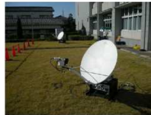
【衛星地球局(可搬型 VSAT)】 【可搬型 VSAT を収納するケース群】
